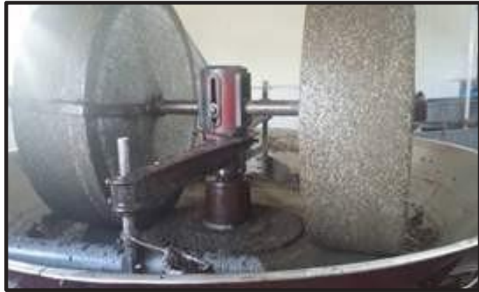
الطحن والجروش باستخدام ماتور كهربى لتحريك الاحجار
